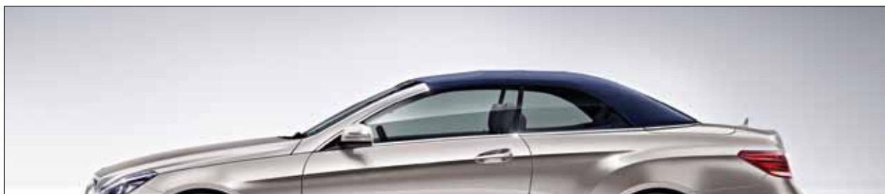
На скорости до 40 км/ч мягкий складной верх поднимается и опускается при помощи переключателя.
