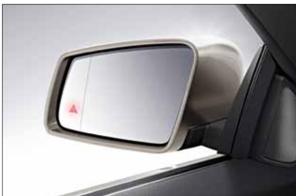
Система удержания полосы движения и система мониторинга «мертвых зон» предупреждают водителя в опасных ситуациях, например, при перестроении.
