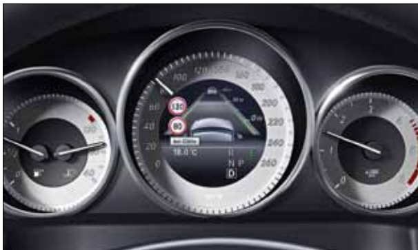
Система распознавания дорожных знаков выводит на дисплей действующие на данном участке пути ограничения скорости и прочие знаки.
