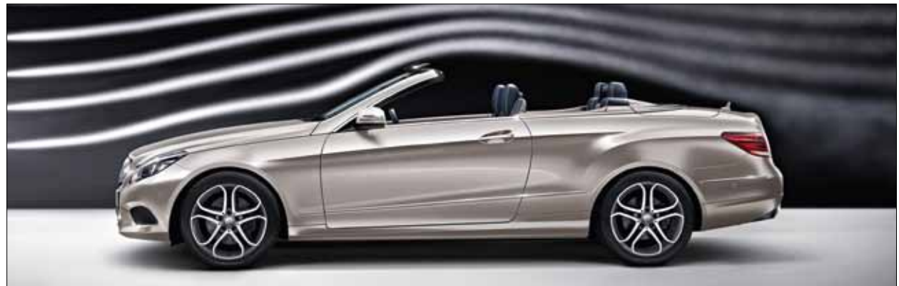
Проще простого: система AIRCAP направляет поток воздуха над головами пассажиров.
