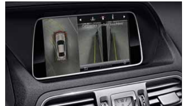
На центральном дисплее системы COMAND Online во время проведения маневра парковки отображается зона вокруг автомобиля.
