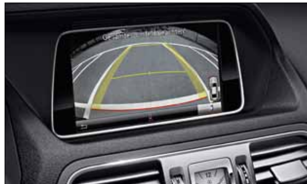
Видеокамера заднего вида посредством статических и динамических линий помогает произвести маневр парковки.
