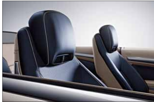
Система отопления в подголовниках AIRSCARF окутывает плечи теплым воздушным шарфом.
